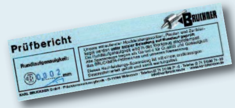
Prüftabelle „Rundlaufgenauigkeit“ am Beispiel Typ S, SG
