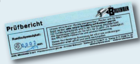
Prüftabelle „Rundlaufgenauigkeit“ am Beispiel Typ ZA, ZAG
