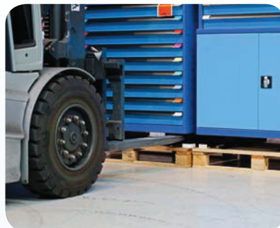
Schritt 2 Entfernen der Transport-Palette
