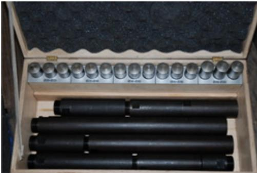
**Stützrohre und Spannbolzen**
