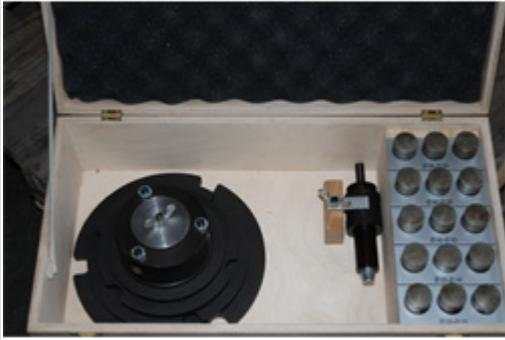
Spanneinsatz und Spannbolzen
