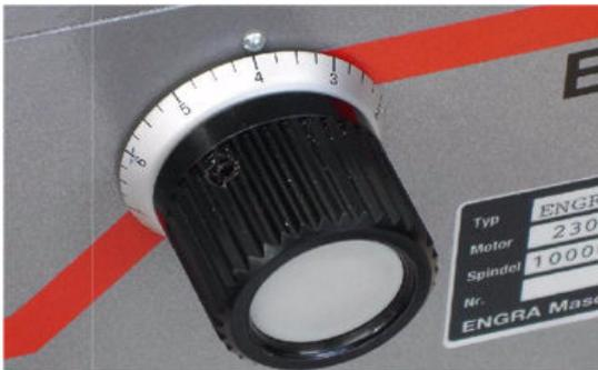
Die **Kantenbruchhöhe** wird über einen Zustellmechanismus mit dem Skalaknopf in Schritten von **0.02 mm** eingestellt
