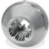
Sonderschneideisen mit beidseitigem glockenartigem Vorbau. Die Fertigung beider Gewinde erfolgt gleichzeitig. Werkzeugaufnahme mittig
