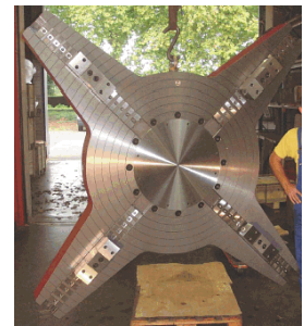
Wescott 4-Backen Sonderdreh- futter D 2500 mm
