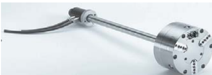
Hochpräzisions-Spannfutter Spanngenauigkeit <1\mu D 50 bis D 200 mm für dünnwandige Teile bei hohen Anforderungen an die Spanniederhol- Genauigkeit – rotierende Ausführungen zum Feindreifen, Schleifen, Honen usw. – stationäre Ausführungen zum Fräsen, Bohren usw.
