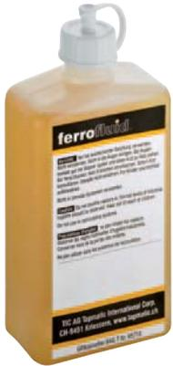
Für die Bearbeitung von zäharten Stählen wie rostfreiem Stahl, Chromnickelstahl usw. ist FERROFLUID ein unentbehrlicher Helfer. FERROFLUID hat hervorragende Antischweiss-Eigenschaften und verhindert die Bildung einer Aufbauschneide, wodurch enge Toleranzen eingehalten und eine hohe Oberflächengüte erzielt werden kann. **VOC-frei.**
